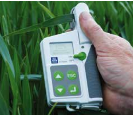
Figuur 16: De Yara N-Tester™ is een handzaam instrument waarmee in het veld de actuele stikstofbehoefte gemeten kan worden.
