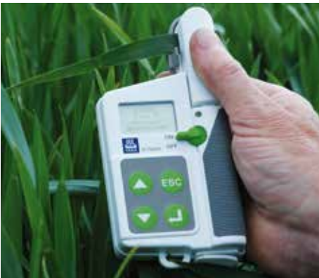
ABBILDUNG 16: Der YARA N-Tester ist ein tragbares Messgerät, mit dem der tatsächliche Stickstoffbedarf von Getreide auf dem Feld ermittelt werden kann.
